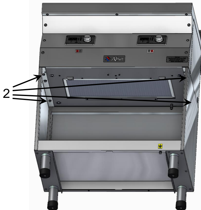
Рис. 6. Установка плит КИП-25Н-3,5 и КИП-25Н-5,0 на подставку (модуль нижний) МН-25
